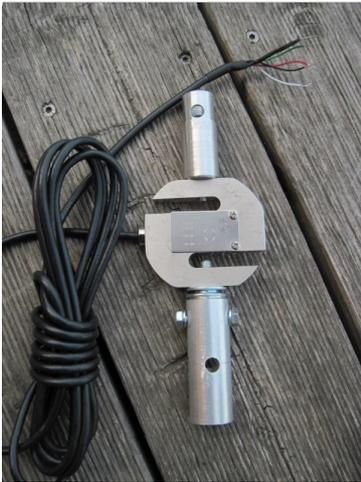
Abb. 1: Wägezelle mit montierten Anschlußstücken
