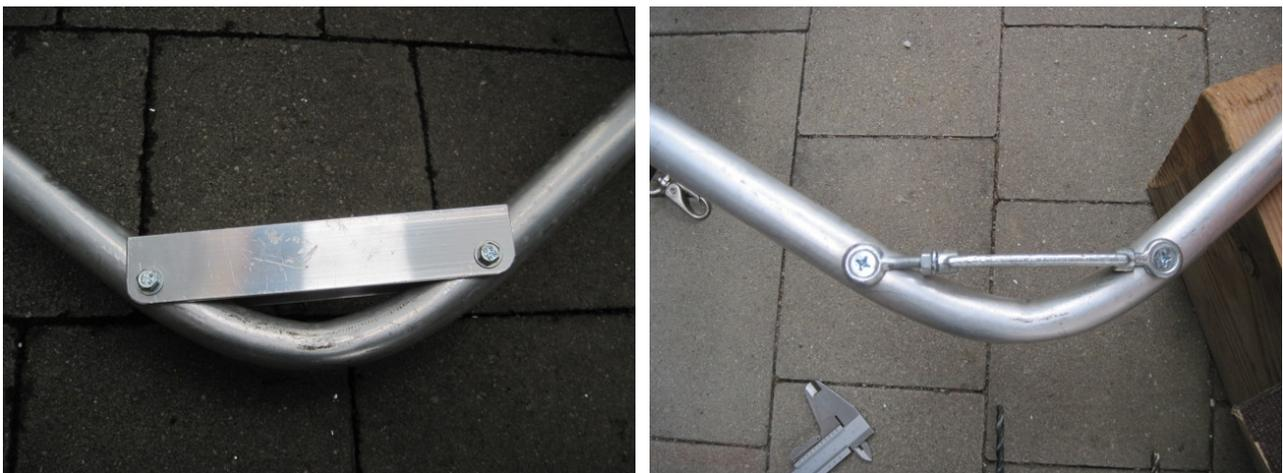
Abb. 24: Aussteifung der ersten Deichselbiegung mit Alu-U-Profil 2 mm (links) und Spannschloss M6 ( rechts).
