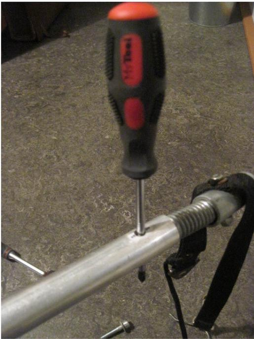
Kupplung mit Schraubendreher o.ä. in richtige Position bringen und wieder zusammen mit Drahtseilschlaufe mit Befestigungsschraube fixieren.
