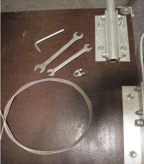
Man benötigt 6er Inbus-Schlüssel, 8er und 13er Gabelschlüssel, 2 ½ m Drahtseil 3 mm und eine oder zwei Drahtseilklemmen.
