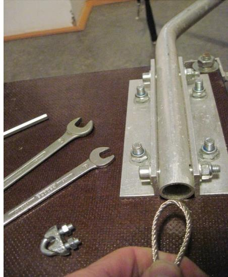
Seil in der Mitte zu einer Öse formen, die man am besten mit Isolierband fixiert und von hinten in die hohle Deichsel hineinschieben. Eventuell Schrauben lösen, damit's besser durchgeht.
