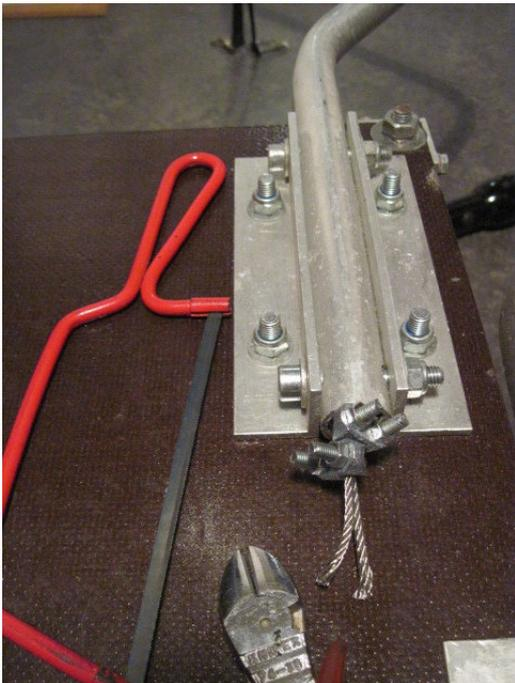
Drahtseilenden passend abzwicken oder absägen und dann mit einer oder zwei Drahtseilklemmen verbinden.
