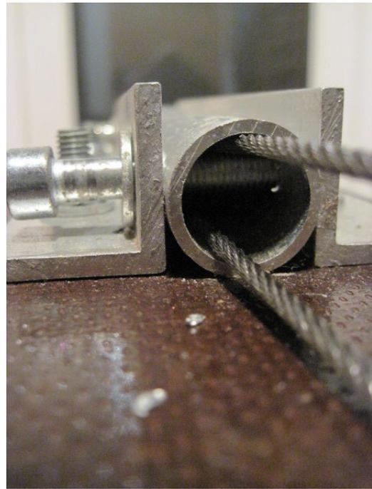
Auf der Rückseite eines der Drahtseilenden über, das andere unter der hinteren Befestigungsschraube durchführen.
